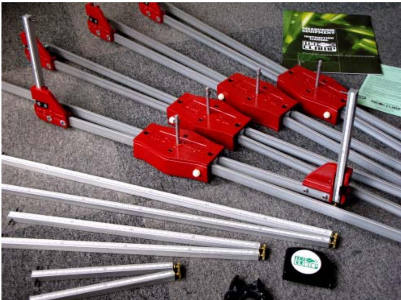
センターリングゲージは車体の下に吊下げて、ダメージ部の左右上下の曲がり・擦れの確認ができます。
